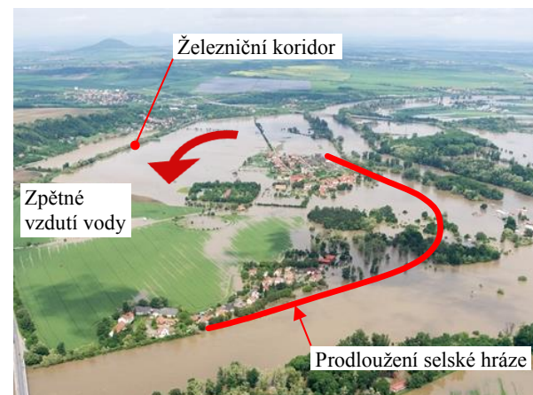
Obr. 9: Schéma zaplavení řešeného území zpětným vzdutím podél železničního koridoru – ve studii řešeno pomocnými hrázemi I a II [20]
